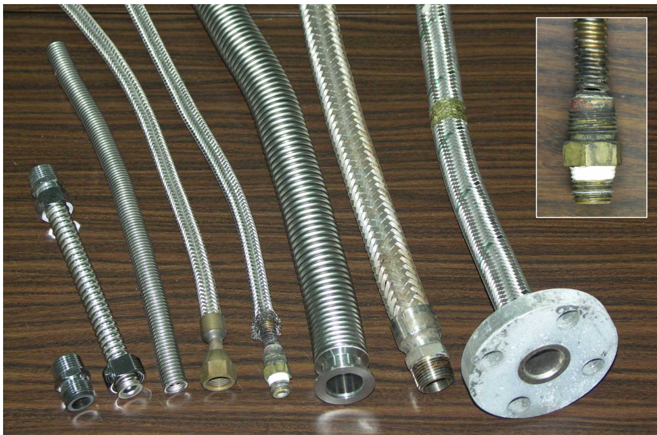
図 1. 様々なフレキシブルチューブと、疲労破壊した付け根（右上）
