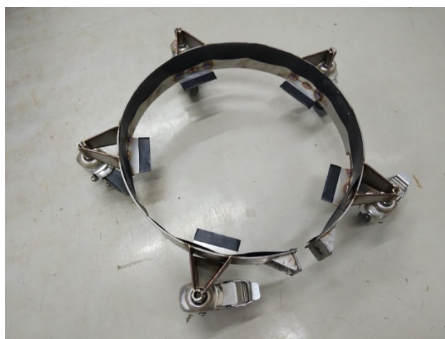
図7 ゴムシートで異種金属を絶縁して防蝕
