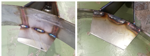
図5 SUSの爪(厚さ3mm 幅8cm)
