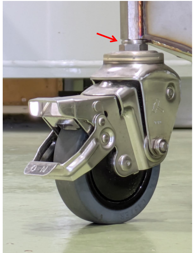
図9 キャスターねじ込み部で高さ調整(①③⑤)
