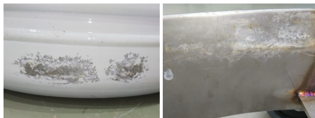
図6 アルミ容器とSUS台車の接触による電蝕
