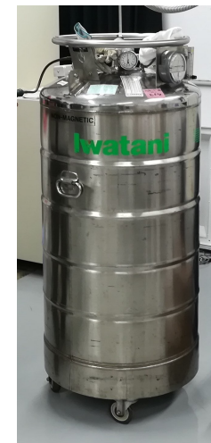
液体ヘリウム -269℃ 断熱容器
