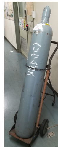
高圧ボンベ 150気圧に圧縮
