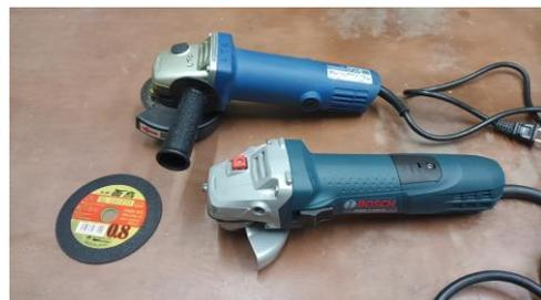
図 3 使用したディスクグラインダーと切断砥石
