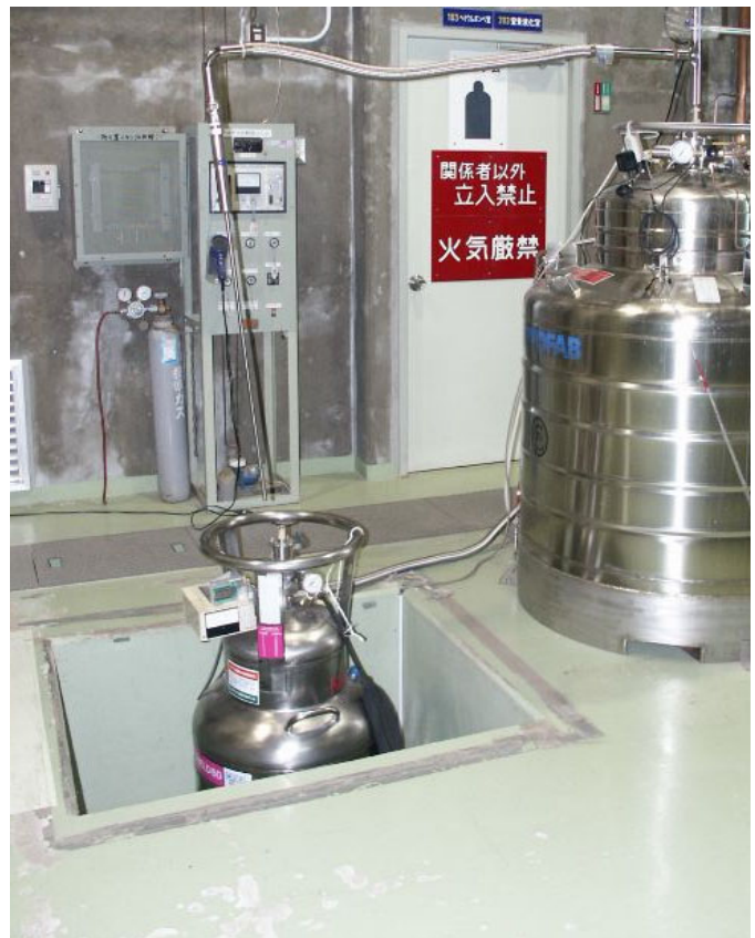
図 1. 冂型トランスファーチューブ (水平部はフレキ、貯槽側は挿してある) と、迫り下げた小分け容器
